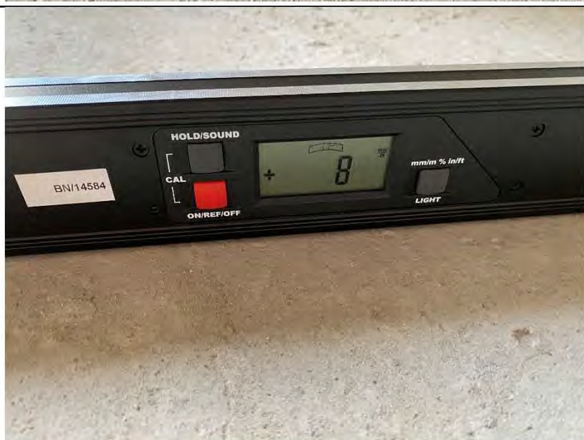
Фото №45. Измерение уровня горизонтальных ж/б элементов в гостиной.
