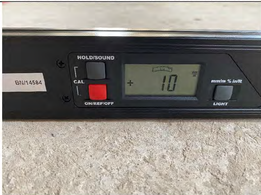
Фото №47. Измерение уровня горизонтальных ж/б в ванной комнате.
