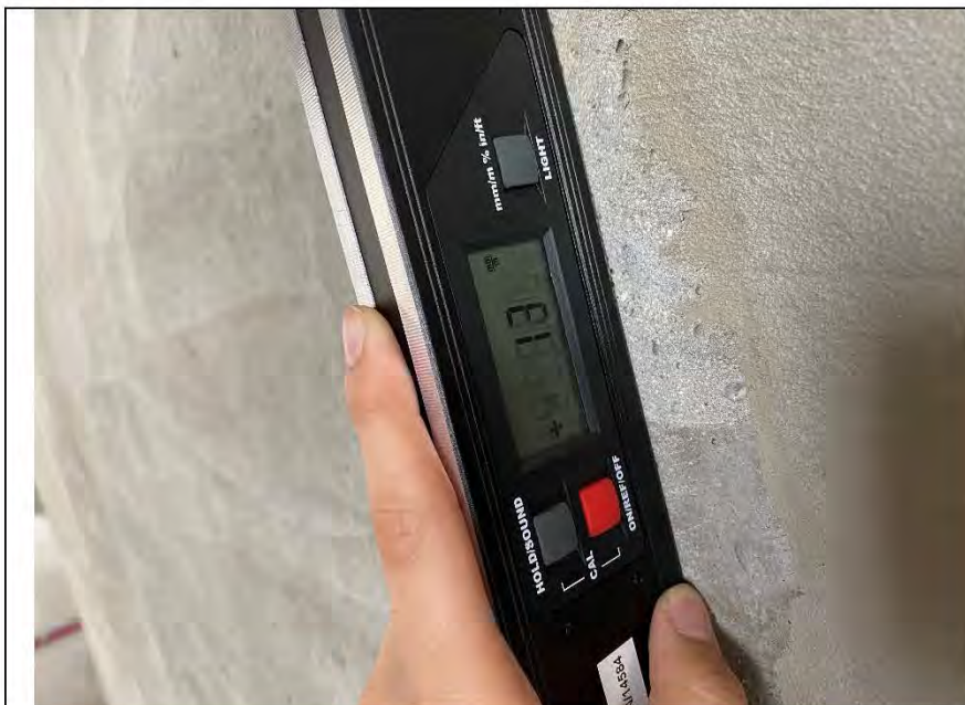
Фото №43. Измерение уровня ж/б стены в спальне.
