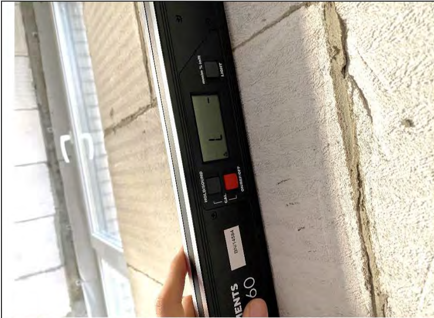
Фото №49. Измерение уровня кладки в спальне.
